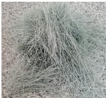
Figura 9. Fibras sintéticas de polietilentereftalato (PET) reciclado
