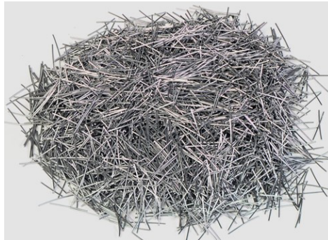
Figura 7. Fibras de acero tipo macro-fibras; especial para concreto lanzado
