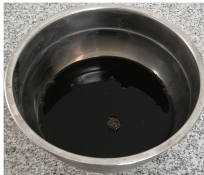
Figura 5. Aditivo fluidizador y Superplastificante SikaPlast® MO
