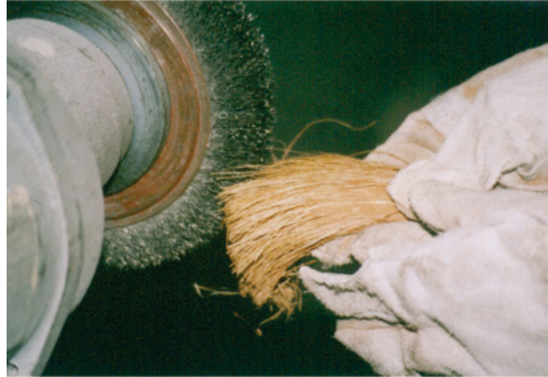
Figura 17. Esmeril utilizado para la extracción de la fibra
