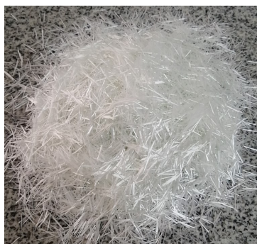
Figura 8. Fibras de vidrio alcalí-resistentes tipo AR Cem-FIL® 60
