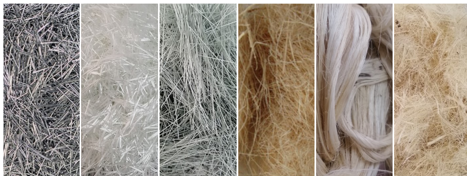
Figura 6. Diferentes tipos de fibras utilizadas para reforzar mezclas de microconcreto
