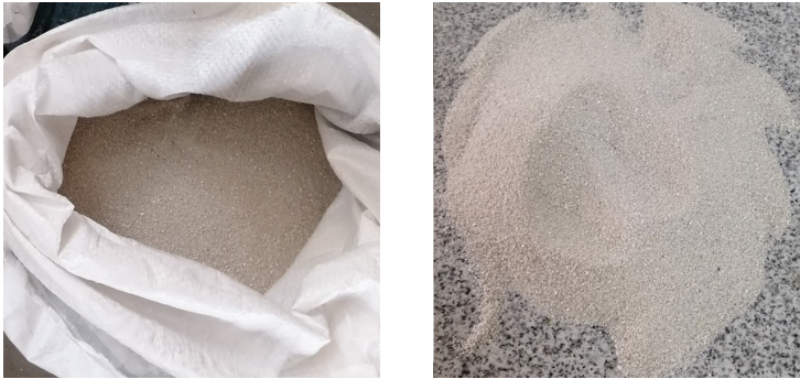
Figura 2. Agregado fino, arena de cuarzo de tamaño de partícula mediano
