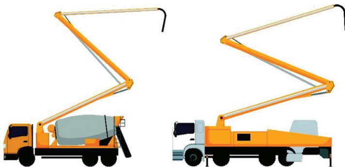
Figura 22. Autobombas de concreto
