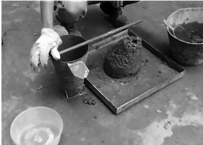
Figura 1.5 Ensayo de asentamiento.
