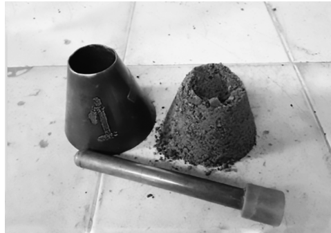
Figura 3.5 Material con humedad superficial.
