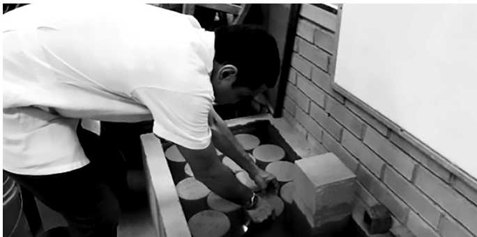
Figura 4.3 Puesta en curado de los cilindros.
