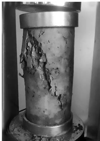
Figura 4.4 Ensayo de resistencia a la compresión.
