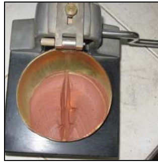
Figura 88. Surco después del ensayo Fuente: Mora Basto, 2015.
