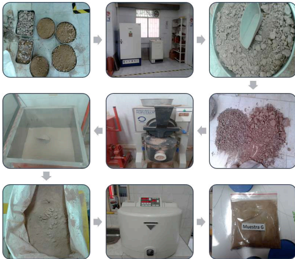
Figura 75. Etapas en la preparación de las muestras
