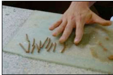
Figura 86. Método de Atterberg – Límite plástico Fuente: Cueva del Ingeniero Civil, 2017.
