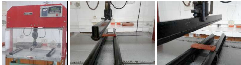
Figura 115. Aplicación ensayo de resistencia a la flexión
