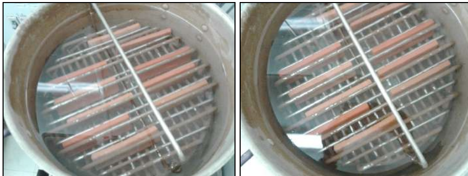
Figura 112. Aplicación ensayo de absorción de agua
