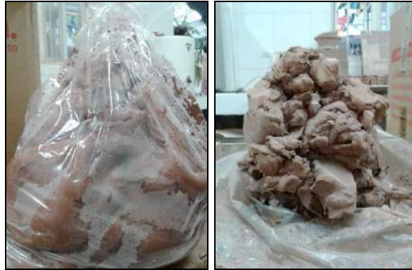
Figura 97. Homogenización de la muestra
