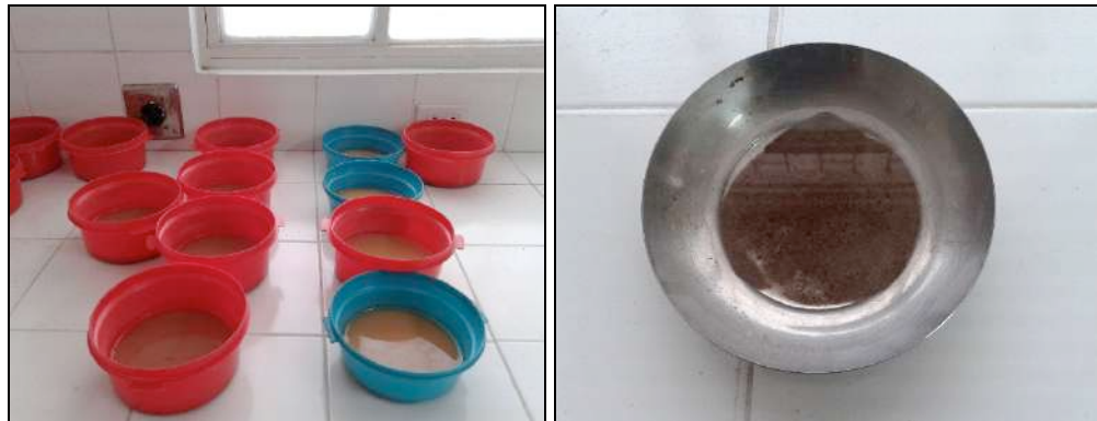
Figura 76. Retenido sobre tamiz ASTM 230
