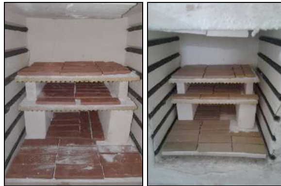
Figura 104. Cocción de las muestras en el horno mufla de laboratorio
