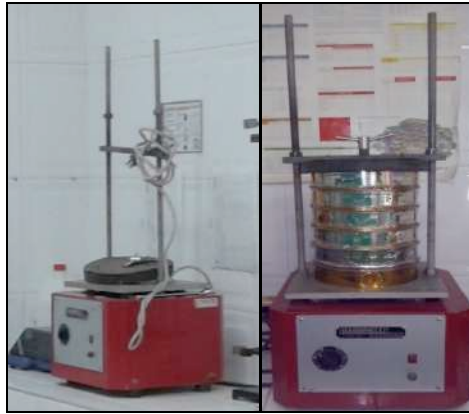
Figura 82. Análisis granulométrico mecánico Aplicando la Ecuación 5, se calcula el porcentaje de material retenido en cada tamiz.
