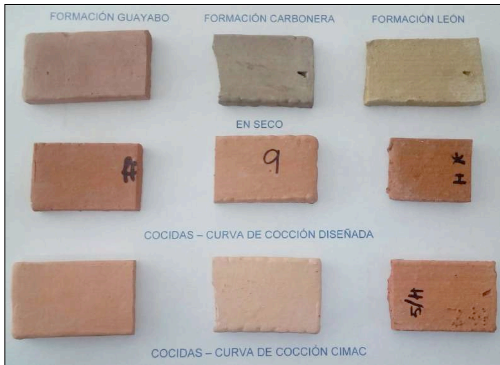
Figura 110. Colores que presentaron las muestras analizadas en secado y cocción
