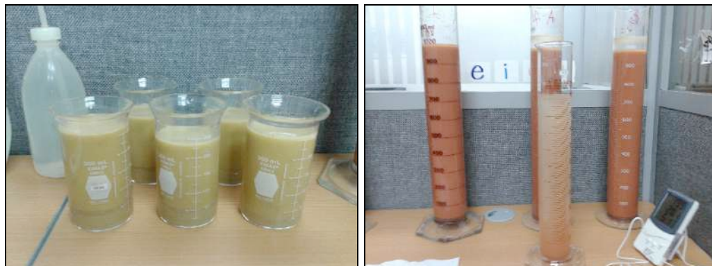
Figura 78. Análisis granulométrico por hidrómetro
