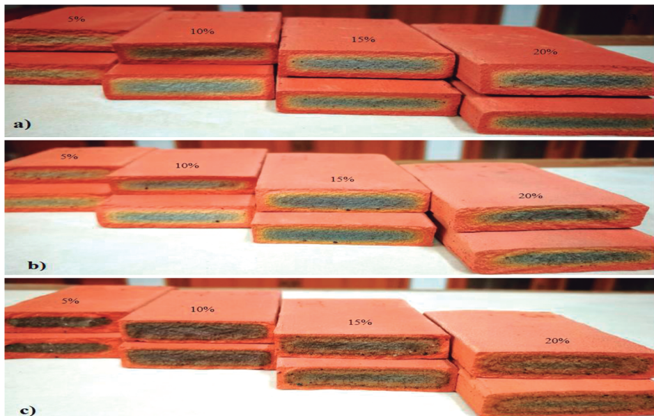
Figura 40. Aspecto de los cerámicos elaborados con material arcilloso e inquemados de carbón como material sustituto
