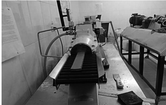
Figura 14. Registro fotográfico de la extrusora usada para el conformado de las probetas
