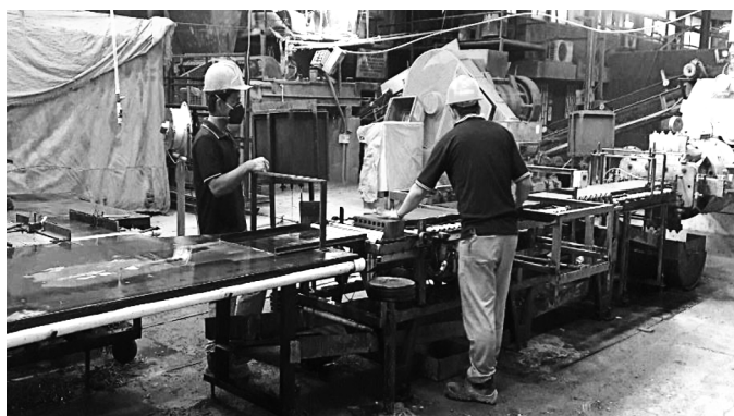
Figura 6. Humectación y moldeo (Ladrillera Casablanca S.A.S., 2016)
