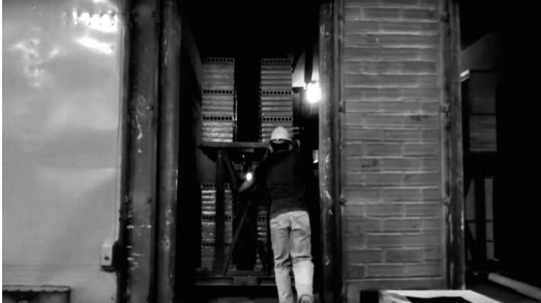
Figura 28. Entrada de productos en el secadero de cámaras (Ladrillera Casablanca S.A.S., 2016)
