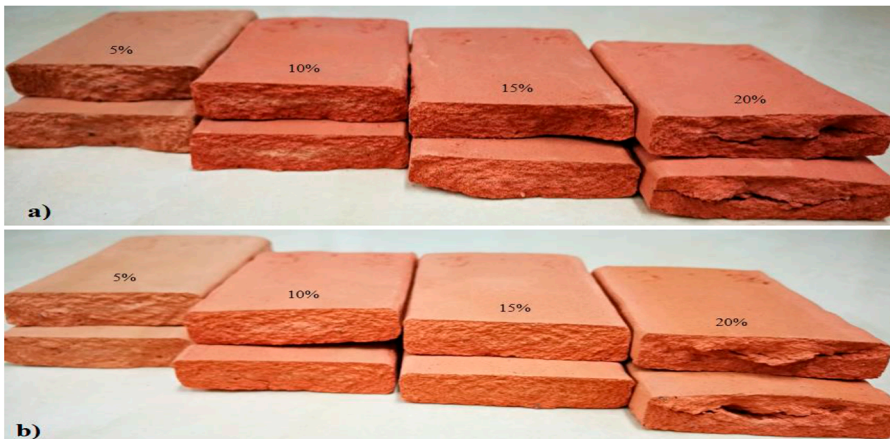
Figura 43. Aspecto de los cerámicos elaborados con material arcilloso (MA) y cascarilla de arroz pasante malla 80 (CAb) como material sustituto
