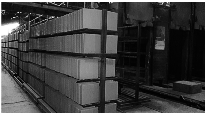
Figura 7. Secado (Ladrillera Casablanca S.A.S., 2016)
