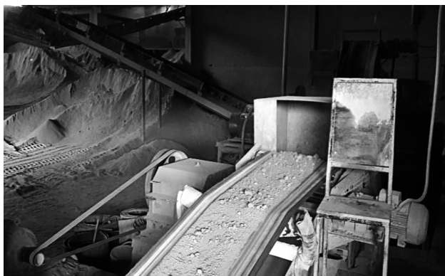
Figura 5. Trituración y molienda de la materia prima (Ladrillera Casablanca S.A.S., 2016)
